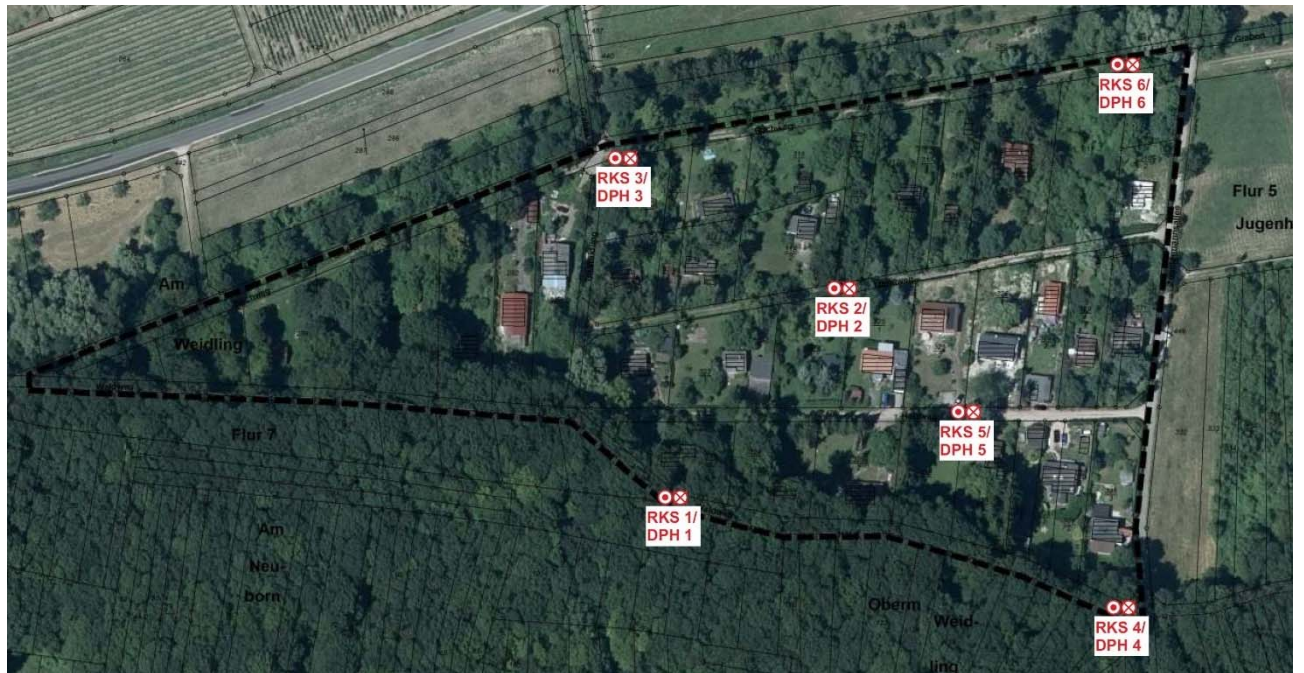
Abbildung 6: Auszug Lageplan mit Darstellung der Untersuchungspunkte, Geotechnischer Bericht Nr. 5024-20, Anlage 1.
